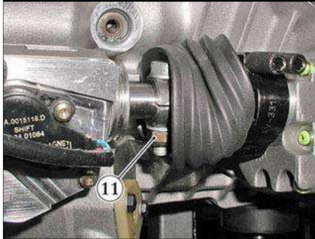
● 松开螺母 **(11)**，并拆下将接头与变速箱控制杆固定在一起的螺钉。
