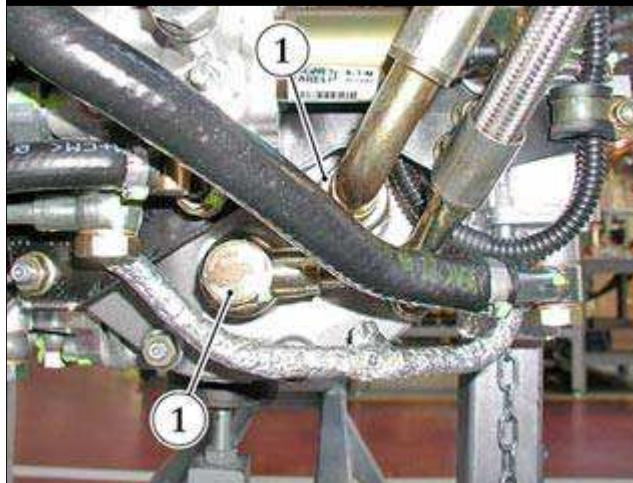
● 松开两个变速箱油管接头 (1)。
