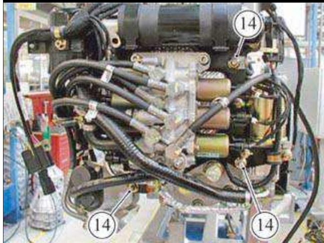
● 松开三个螺母 (14) 并拆卸动力单元和执行器以及连接管。
