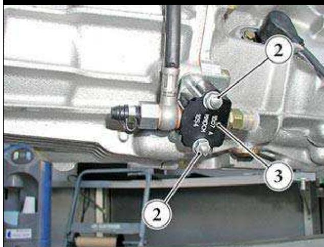
● 松开两个螺母 (2) 并从变速箱拆卸接头模块 (3)。
