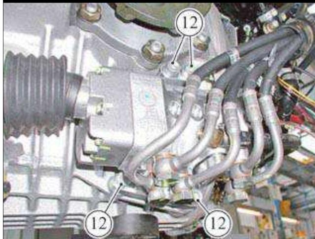
● 松开将执行器固定至变速箱的四个螺钉 **(12)**。
